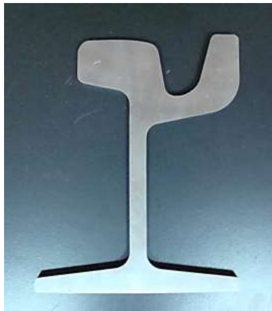
Рисунок 10 – Темплет поперечного сечения трамвайного рельса после прокатки НЛЗ с максимальной осевой пористостью
